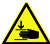
An fremdkraftbetätigten (z.B. hydraulisch bewegten Teilen) befinden sich Quetsch- und Scherstellen!
